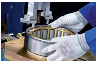
Горячая клёпка латунных сепараторов
